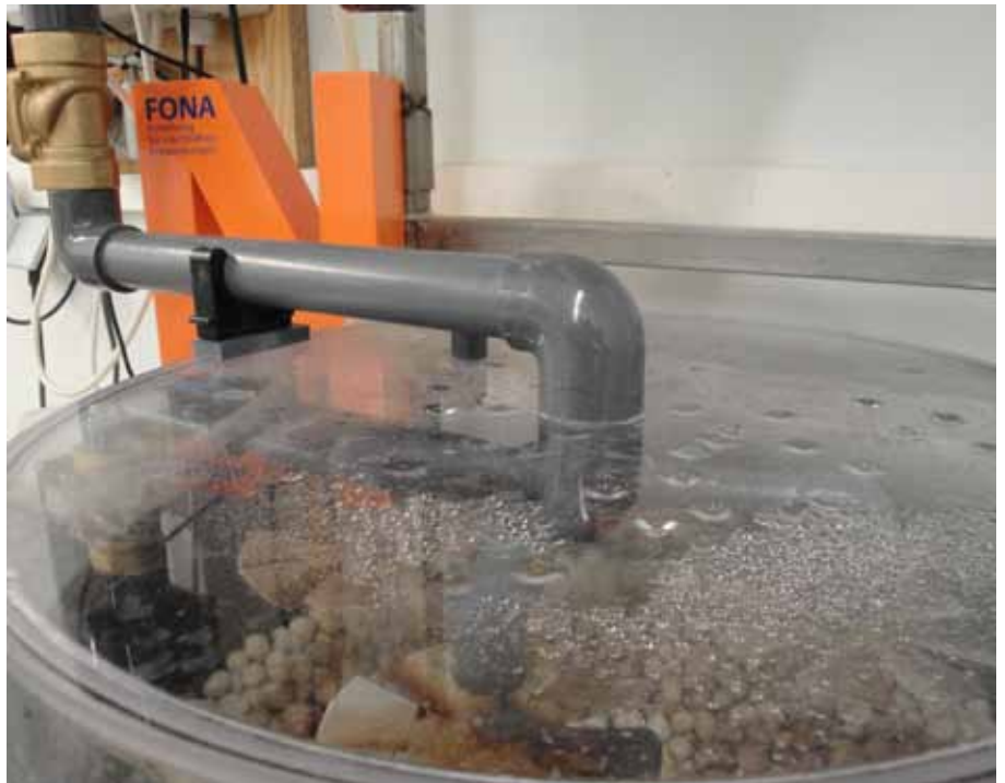
Versuchstropfkörper zur Grauwasserbehandlung
