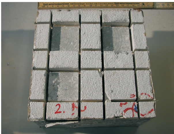
Abb. 2 Verbundprobe ohne Haftbrücke nach Prüfung der Haftzugfestigkeit. Zu sehen ist ein vollständiges Adhäsionsversagen an der Grenzfläche Beton/Gipsputz.
